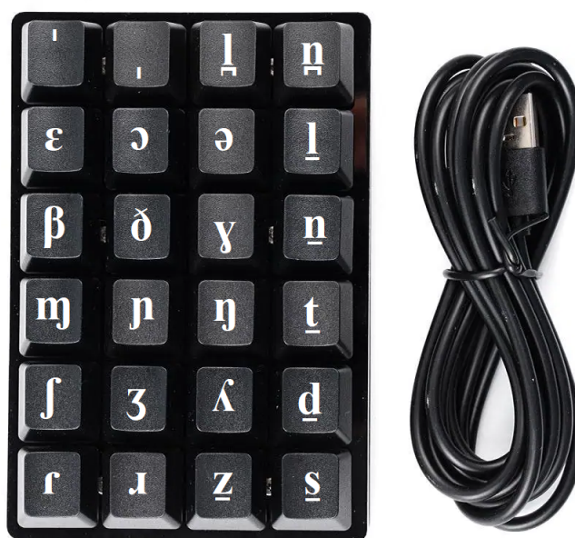
Figura 1. Adaptación de un teclado macro para la transcripción fonética (catalán)
