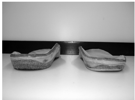
Fig. 4. Tratamiento con resina
