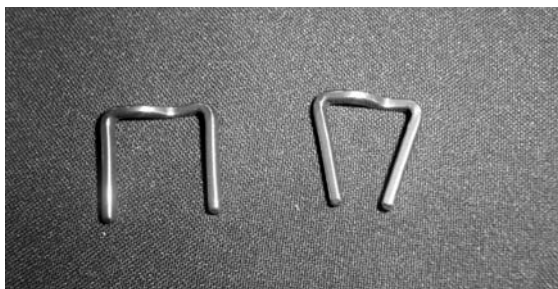
Figura 5. Cambio de forma de la grapa de compresión por aplicación de calor.
