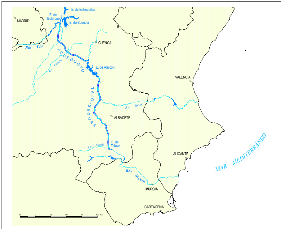
Figura 6. Esquema del trazado del trasvase Tajo-Segura. Se aprecia claramente como esta infraestructura hidráulica interconecta cuatro grandes cuencas hidrográficas y con el canal del postravase hasta la del río Almanzara.
