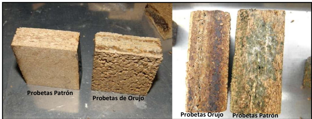
Figura 4. Probetas Patrón y de Orujo- desarrollo de hongos producto de la humedad
