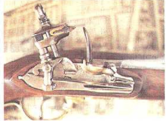
Pistola de Guardias de la persona del Rey (primer modelo) con llave de «patilla» (principios del siglo XIX).
