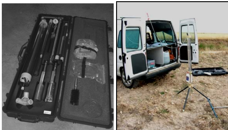
Figura 2. Permeámetro de Guelph y ensayo de campo.
