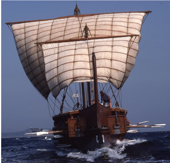
Figura 3. Las velas de la nave Olympias (reconstrucción fiel de una antigua trirreme ateniense) mientras navegaba cerca de la isla de Poros (Grecia) en 1988. Nótese los retazos rectangulares unidos por medio de costuras. Imagen cortesía del Trireme Trust Collections, Wolfson College Archive, fotógrafo Paul Lipke.
