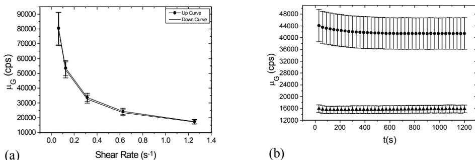
**Figura 2.** Comportamiento tixotrópico del gel CMC. (a) Evolución de la viscosidad del gel  $\mu_G$  en función del gradiente de cizalla o “shear rate” para un gel de gran viscosidad. (b) Evolución temporal de la viscosidad del gel  $\mu_G$  para un gel más viscoso (●) y otro menos viscoso (▲).
