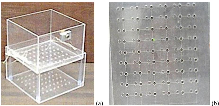
**Figura 3.** (a) Fotografía del sistema de cajas móviles, construidas en metacrilato, que se usa para la deposición de la capa densa. (b) Fotografía de los fondos de las 2 cajas agujereadas de metacrilato. Se observa la disposición alternante de los respectivos orificios (6 filas con 9 orificios cada una).
