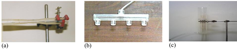
**Figura 5.** (a) El tubo venturi actúa como una pequeña bomba de succión que permite que los fluidos asciendan por el interior de las sondas de conductividad. (b) El conector múltiple permite que las cuatro sondas de conductividad se conecten simultáneamente a un mismo tubo venturi. (c) El vaso regulador del flujo controla el caudal de entrada en el venturímetro evitando las fluctuaciones del grifo de alimentación.
