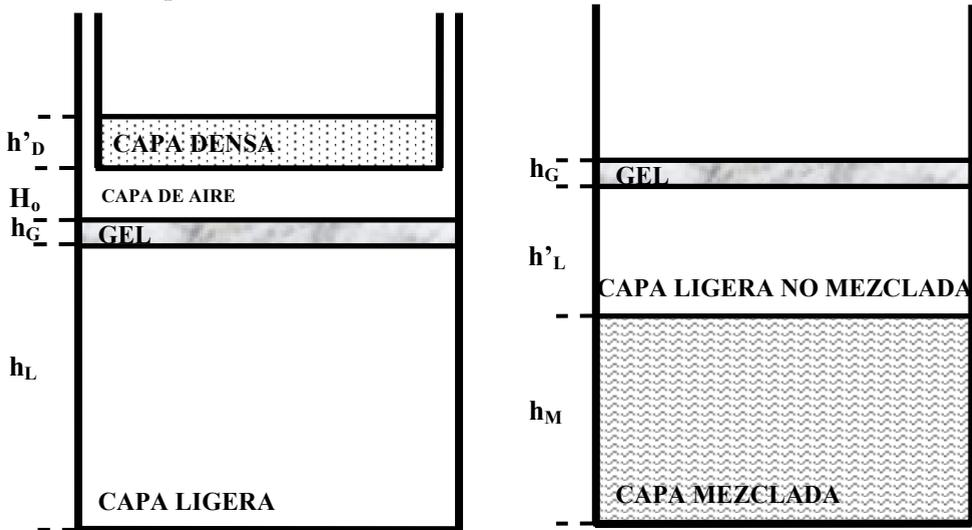
**Figura 1.** Esquema del modelo de laboratorio. La figura de la izquierda esquematiza el estado inicial del sistema fluido experimental. La figura de la derecha muestra el estado final del sistema fluido tras el proceso de mezcla turbulenta.
