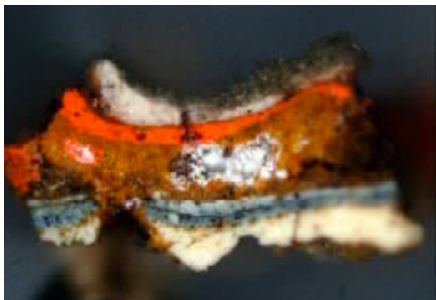
Fig. 7. General view of sample AG2 showing the stratigraphy of the polychromy of the Agramunt portal, observed under an optical microscope. Source: © CRBMC (Centre de Restauració de Béns Mobles de Catalunya), Façana de l'Església de Santa Maria d'Agramunt , Patrimoni-UB, Barcelona, 2006, p. 34.
