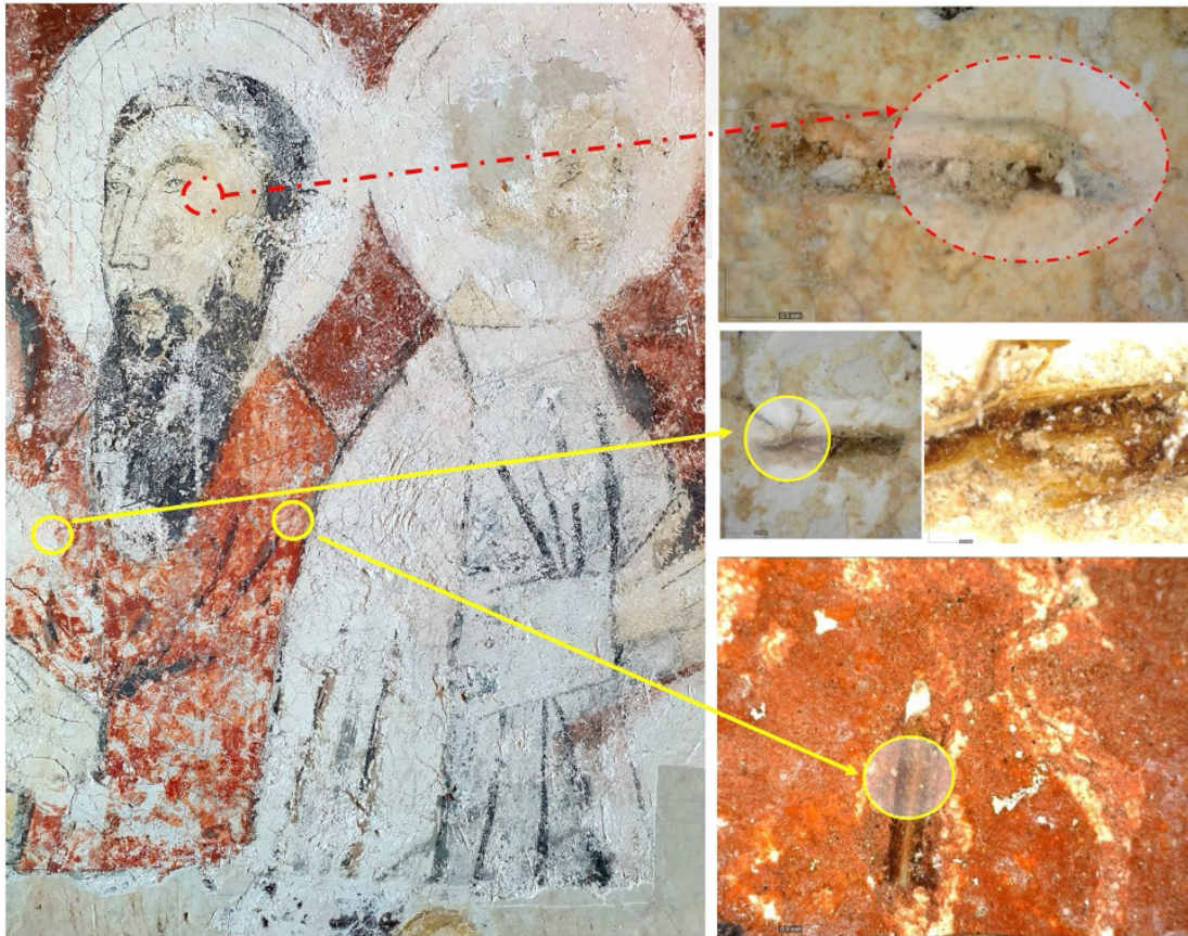
Fig. 11. Detalle de las virutas de madera integradas en el mortero. Superior: detalle del apóstol de la Última Cena , donde se aprecia la integración de fragmentos de madera en el soporte mural: imágenes de microscopía digital (50× y 200×) que muestran la morfología de las virutas de madera. Fotos: los autores.
