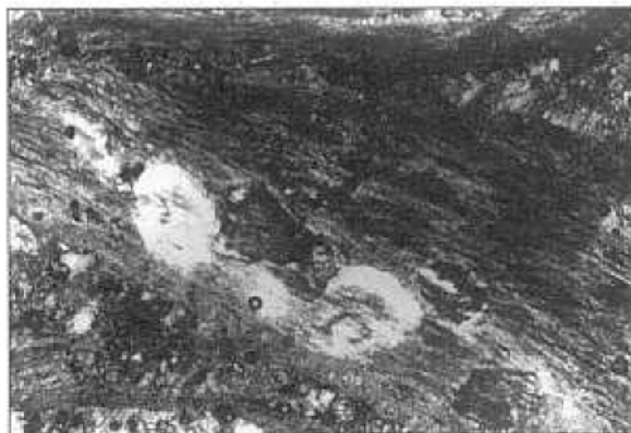
Foto 7.- Detalle de la silicificación parcial en desgrasantes calcáreos bioclásticos de la muestra San Martín-12. Ancho de la fotografía: 1.6 mm.
