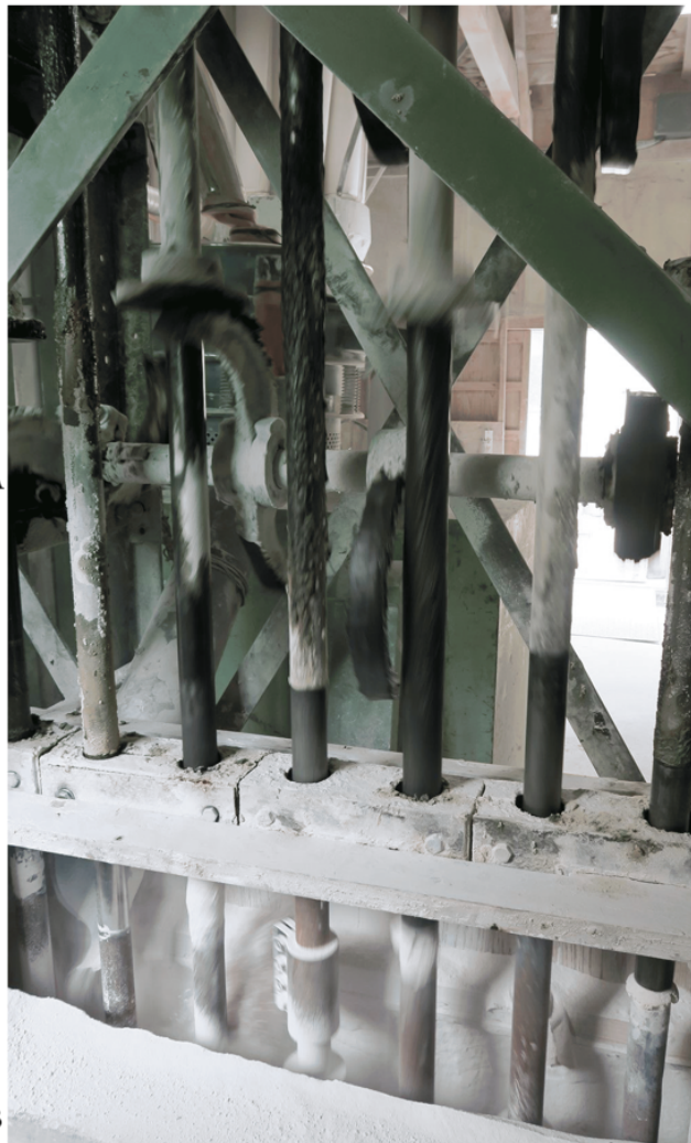
Figura 5A. Clasificación manual. Figura 5B. Máquina pulidora. Figura 5C. Molino de pisón de acero. (Fotos autorizadas por el fabricante Nakagawa Gofun Enogu).
