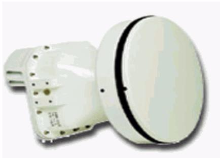
La antena de usuario, como la que aparece en la fotografía, puede ser una caja cuadrada de 16x 16 cm<sup>2</sup> o de sección circular de 20 cm de diámetro aproximadamente, situada en la parte más alta del edificio. La antena capta la señal emitida por el distribuidor y la unidad de interfaz de red la convierte en voz, vídeo y datos, y la distribuye por todos los cables existentes en la planta del edificio .
