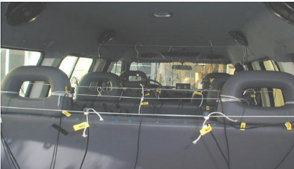
Foto de la furgoneta donde se puede apreciar la red de micrófonos-altavoces.
