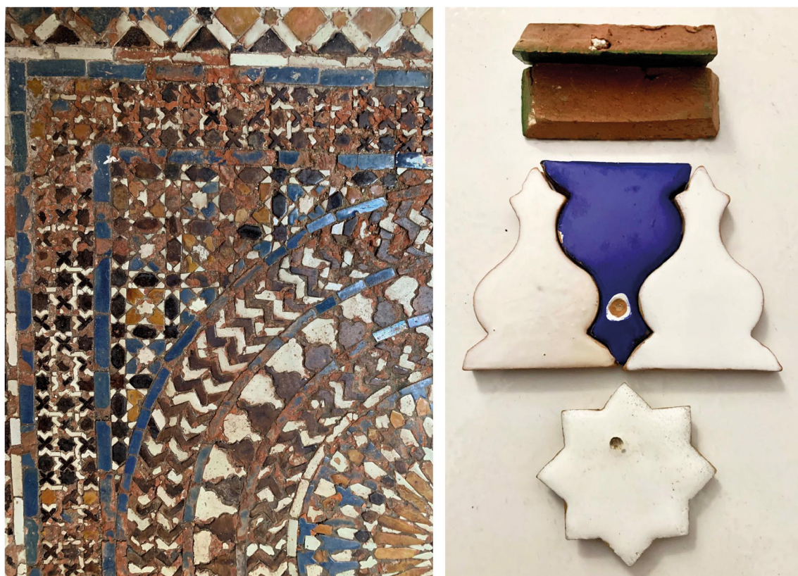
Desgaste del esmaltado del zellige colocado en el suelo (Casa Bricha, Tetuán), y efecto del carbonato cálcico en la cocción a altas temperaturas en el bizcocho y en el esmaltado en piezas de zellige tetuaní. Fotografías: Antonio Reyes.
