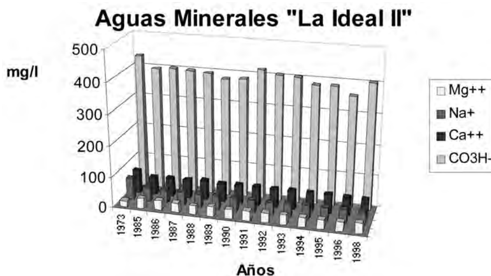
Fig. 1: Representación gráfica de la constancia diacrónica de los iones mayoritarios de las Aguas Minerales de Firgas.
