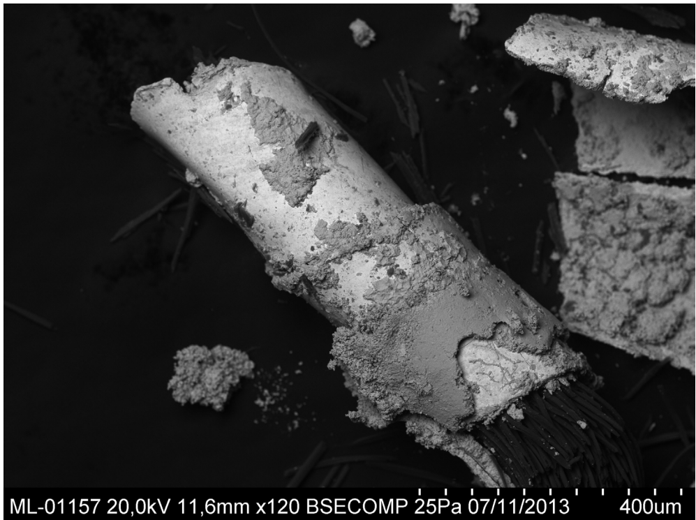
Fig. 3. Fotografía del microscopio electrónico en donde se puede ver la capa de sulfuros del hilo de muestra analizado y cómo la suciedad se acumula en las fibras (Microlab del CSIC, fotografía realizada por Oscar García-Vuelta).
