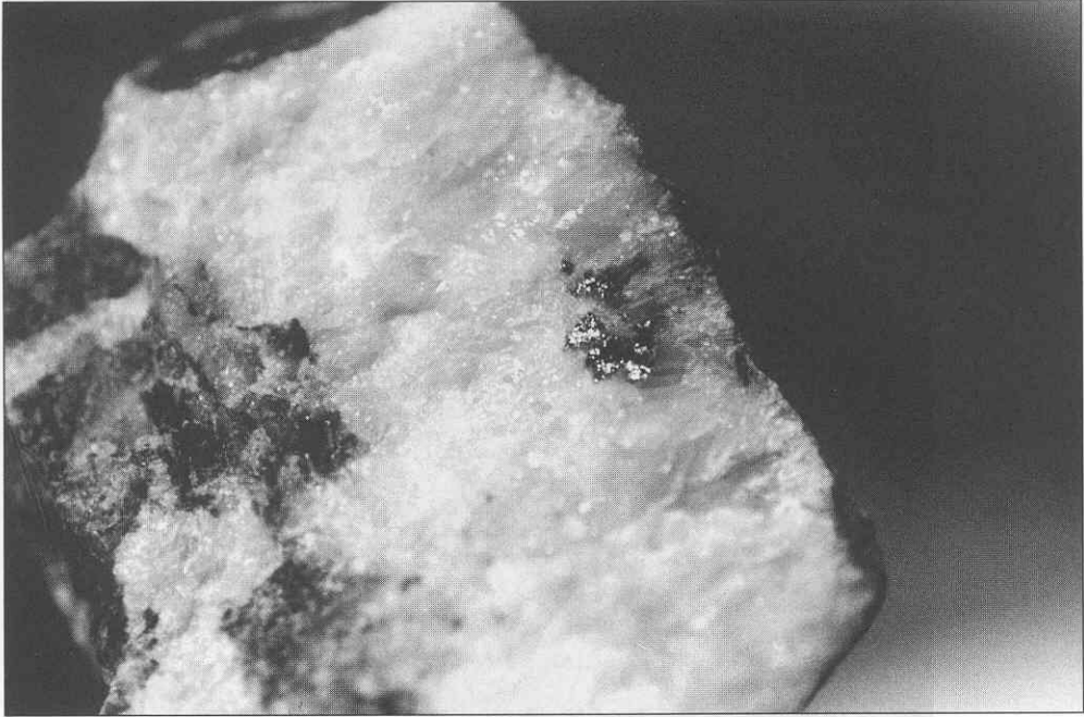
Figura 6. Muestra de cuarzo con mineral de plata (freibergita). El tamaño de la parte mineralizada es de aproximadamente tres milímetros, formando un agregado de cuatro cristales.
