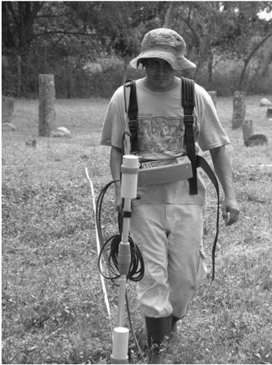
**Figura 2:** Mediciones del gradiente magnético vertical realizadas a lo largo de un perfil en el yacimiento arqueológico de El Caño con un magnetómetro de vapor de cesio G-858
