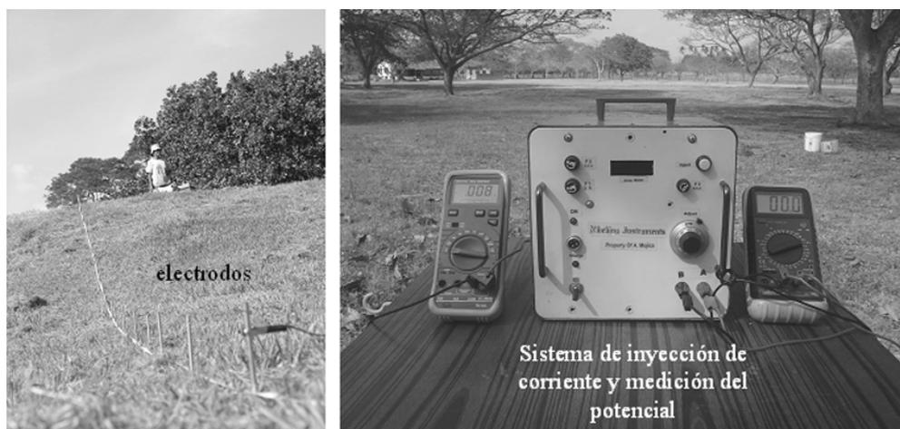
**Figura 4:** Montaje experimental y sistemas de inyección de corriente alterna y de medición
