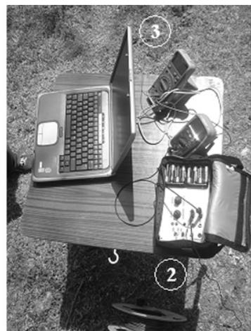
**Figura 3:** Mecánica de registro de la resistividad eléctrica del subsuelo: (1) dispositivo móvil de electrodos, (2) fuente de corriente alterna y (3) adquisición automática de datos
