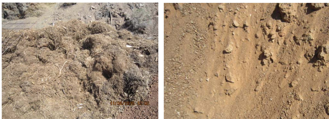
Figura 1. Tierra y triturado de jardinería empleados en la pantalla.
